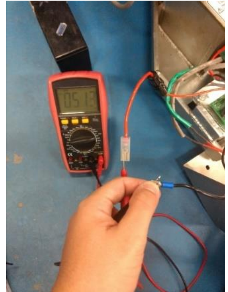
Figura 7 – Medición de la entrada de la placa del cargador
