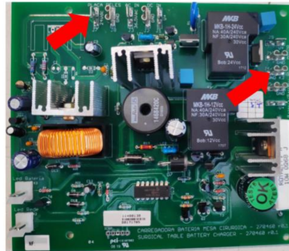
Figura 9 – Medición del voltaje de los pines 24Vdc y RL
