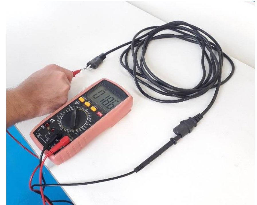
Figura 2 – Prueba de continuidad del cable de alimentación
