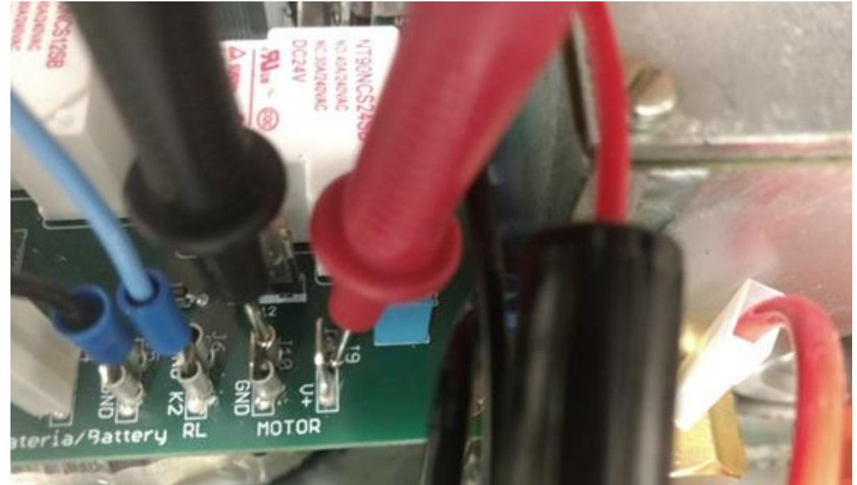
Figura 10 – Medición del voltaje de los pines del “Motor”
