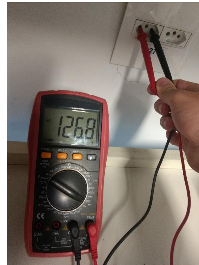
Figura 1 – Medición de voltaje proporcionada por el Cliente
